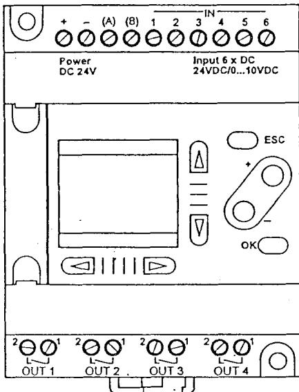
Programovatelná řídící jednotka nevyžaduje v normálním případě žádné přeprogramování – ani montérem, ani provozovatelem. Přístroj je naprogramován a připraven přímo k zapojení. Po delší době skladování (kdy není přístroj pod napětím) však může nastat situace, že se program zastaví (to platí pouze pro náhradní přístroje!). Pozná se to podle toho, že „Signalizace provozu“ již neblíká. Na displeji se objeví např. následující sdělení.
