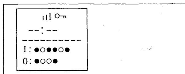
01 = zapnuto, relé K1 je nahozeno a běží čerpadlo P, protože je l6 zapnuto = Prog. 2 zapnuto
